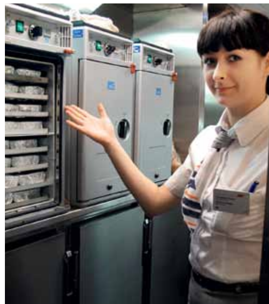
В конвектоматы, которыми оснащены вагонные кухни, загружают кассеты с горячим питанием, скомплектованные на комбинате
